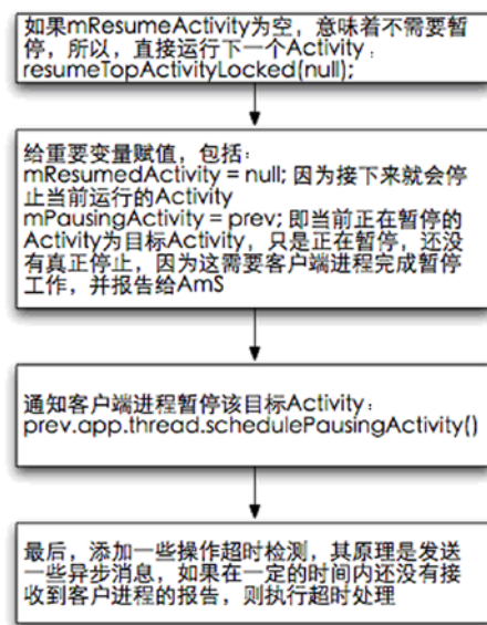
图 10-15 startPausingLocked() 的内部流程
