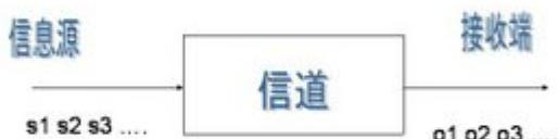
其中  $s_1, s_2, s_3 \dots$  表示信息源发出的信号。 $o_1, o_2, o_3 \dots$  是接受器接收到的信号。通信中的解码就是根据接收到的信号  $o_1, o_2, o_3 \dots$  还原出发送的信号  $s_1, s_2, s_3 \dots$ 。
