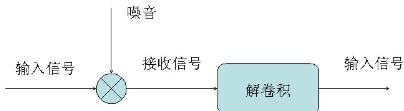
在图中，原始的信号混入了噪音，在数学上相当于两个信号做卷积。噪音消除的过程是一个解卷积的过程。这在信号处理中并不是什么难题。因为第一，汽车发动机的频率是固定的，第二，这个频率的噪音重复出现，只要采集几秒钟的信号进行处理就能做到。从广义上讲，只要噪音不是完全随机的、并且前后有相关性，就可以检测到并且消除。（事实上，完全随机不相关的高斯白噪音是很难消除的。）
