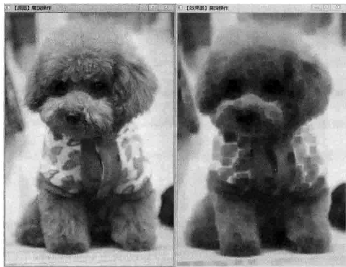
图 6.25 腐蚀效果图（照片）
