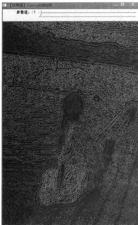
图 7.12 canny 边缘检测效果图 (1)
