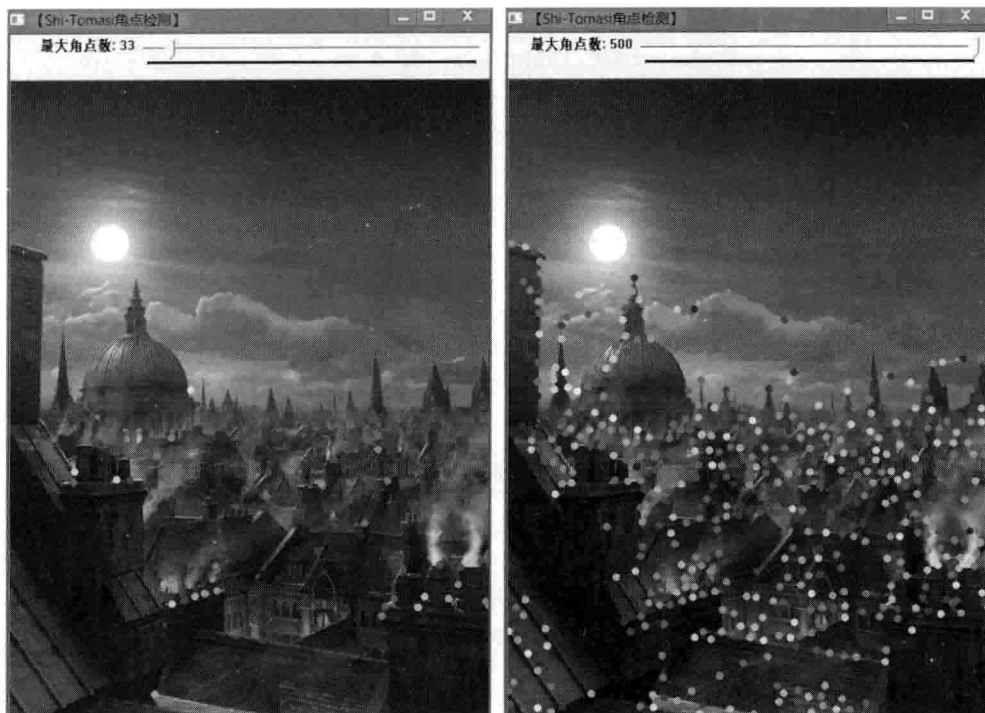
图 10.9 最大检测角点数为 33 时程序截图 图 10.10 最大检测角点数为 500 时的程序截图
