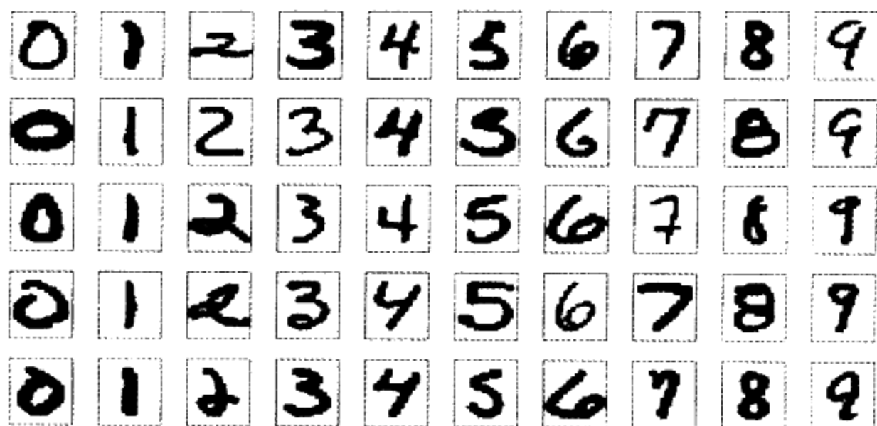
图 11.9 ZIP 编码数据的训练实例。每幅图像是手写数字的 16 \times 16 的 8 位灰度表示
