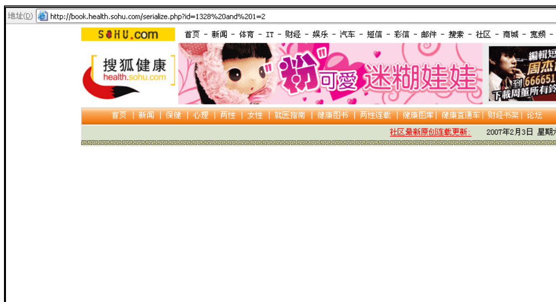
图 2-28 加上 and 1=2 之后页面返回不正常，由此说明存在漏洞
