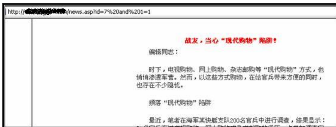
图 7-1 输入 and 1=1 后返回正常
