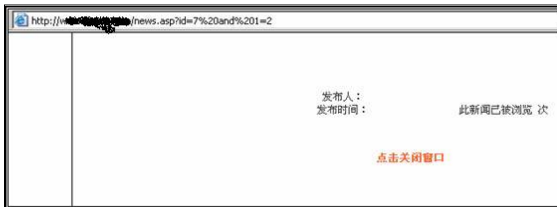
图 7-2 输入 and 1=2 后返回正常
