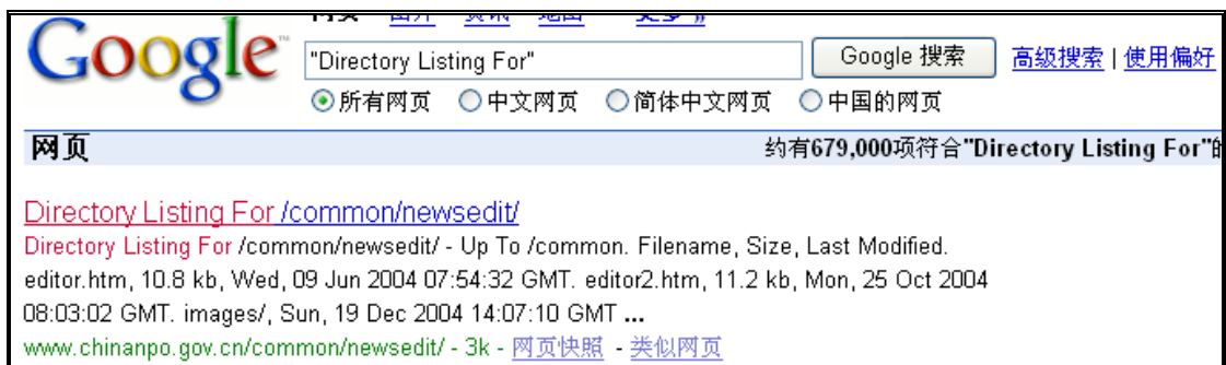
图 14-31 Tomcat 服务器的遍历漏洞
